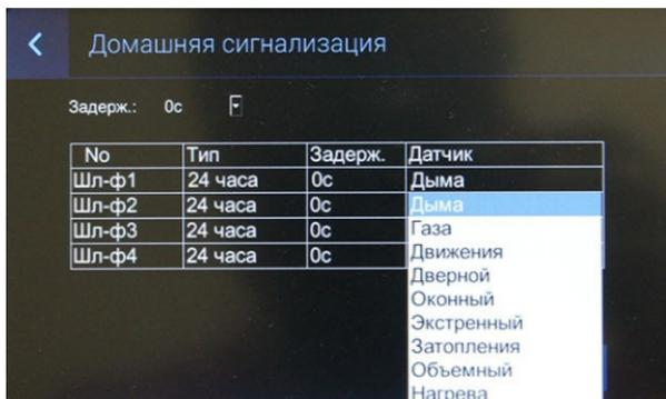
Когда работает любой из датчиков, установленных на любом из активных шлейфов, то на внутреннем мониторе будет отображен номер сработавшего шлейфа, название подключенных датчиков и выведен сигнал на сирену.
