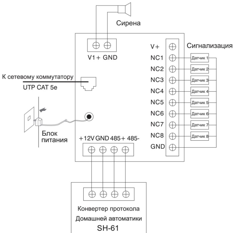
Подключение разъемов на задней стенке внутреннего монитора.
