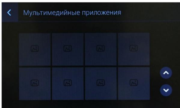
Когда внутренний монитор бездействует в течении 2 минут, он переходит в режим фоторамки, и при этом считывает изображения находящиеся на SD-карте. В случае когда на SD-карте отсутствуют изображения, монитор в режиме ожидания будет отображать часы. Также в режиме ожидания вместо фоторамки или часов можно вывести изображение с одной из подключенных IP-камер.
